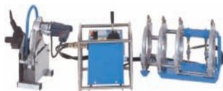
**Modelos:** Shop (manual), Field (hidráulica), Socket (tanto estilo de mano como de mesa de trabajo), Electrofusión, Aire Caliente y Soldadoras de Extrusión.
